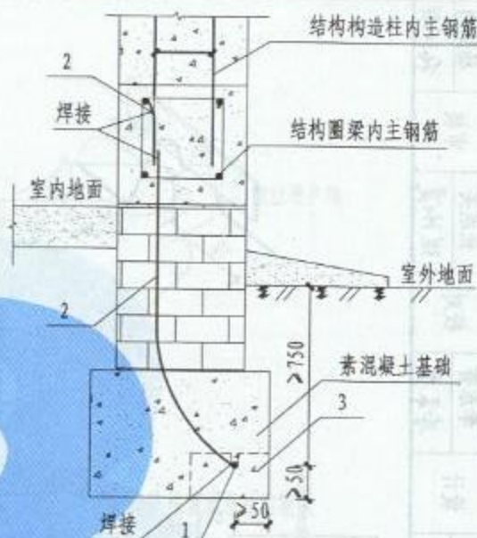
敷设在无钢筋混凝土基础内的圆钢接地极
