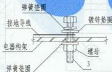
金属构架接地做法
