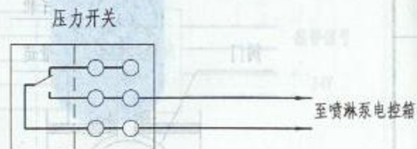
水压力开关接线图(二)
