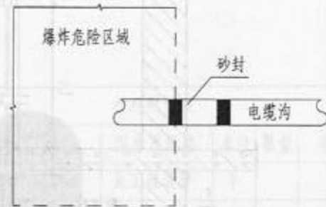
由室外引入爆炸危险区域电缆沟密封位置平面图
