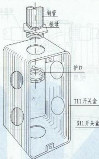
钢管与铁接线盒连接做法
