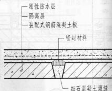
C 预制钢筋混凝土屋面板板缝构造
