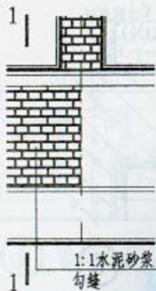
① 烧结砖墙 ② 水泥抹面
