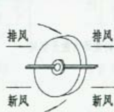
转轮式热回收装置示意图
