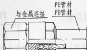
挤压夹紧式连接
