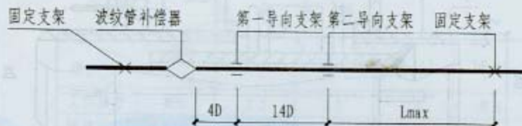
轴向式波纹管补偿器固定支架与导向支架分布示意图
