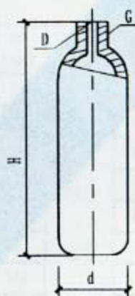
灭火剂储瓶结构图
