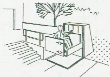
a 呼叫按钮立面示意 ② 垂直式轮椅升降平台透视图
