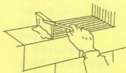
电动切割机开槽
