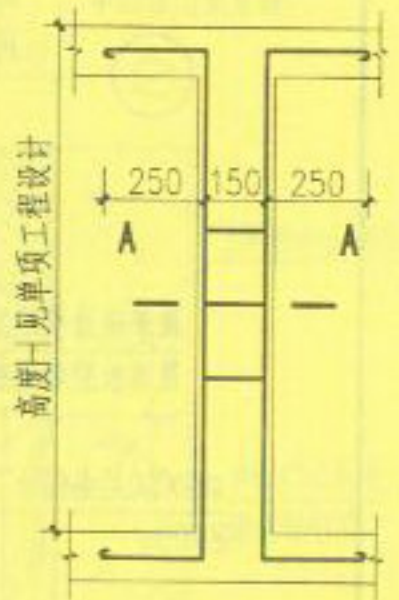
⑤女儿墙构造柱 (现浇C25混凝土)
