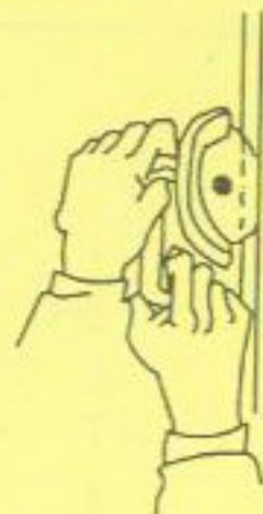
电动切割机开槽
