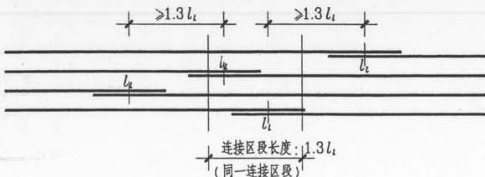
同一连接区段内纵向受拉钢筋绑扎搭接接头
