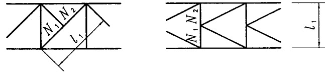
(a) 再分式腹杆体系的受压主斜杆
