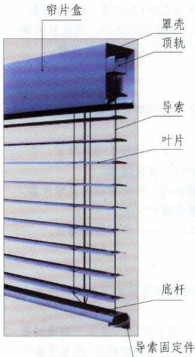
图1 导索系统示意
