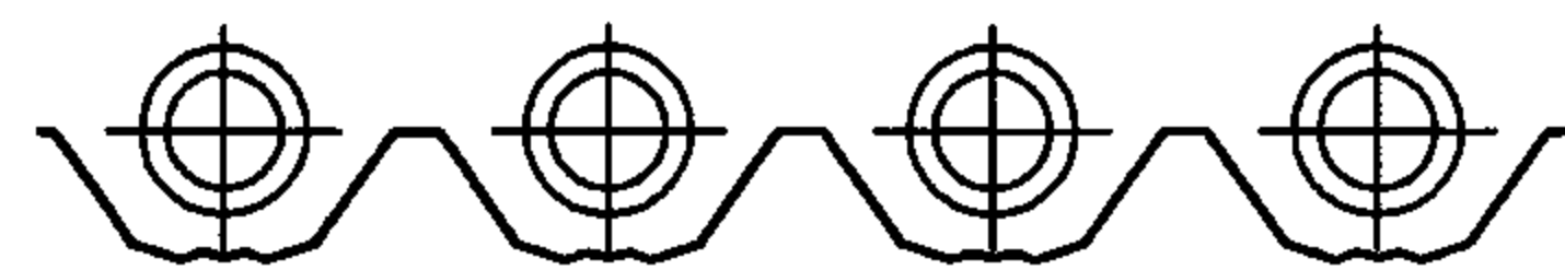
带截短CPC反射器的 真空管太阳能集热器
