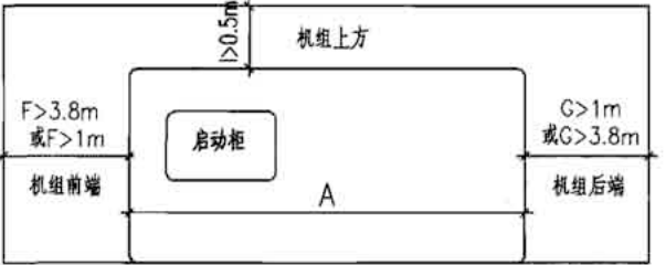
立面图 注: 抽管长度3.8m.
