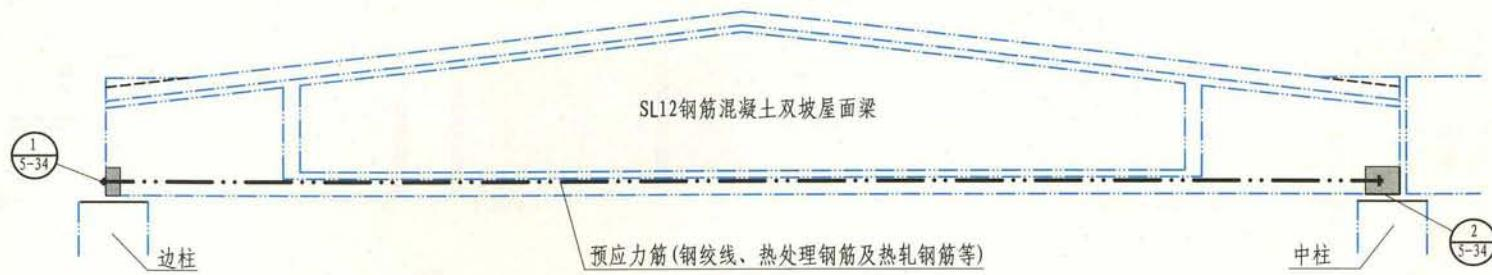
预制梁水平预应力拉杆加固, 机械张拉
