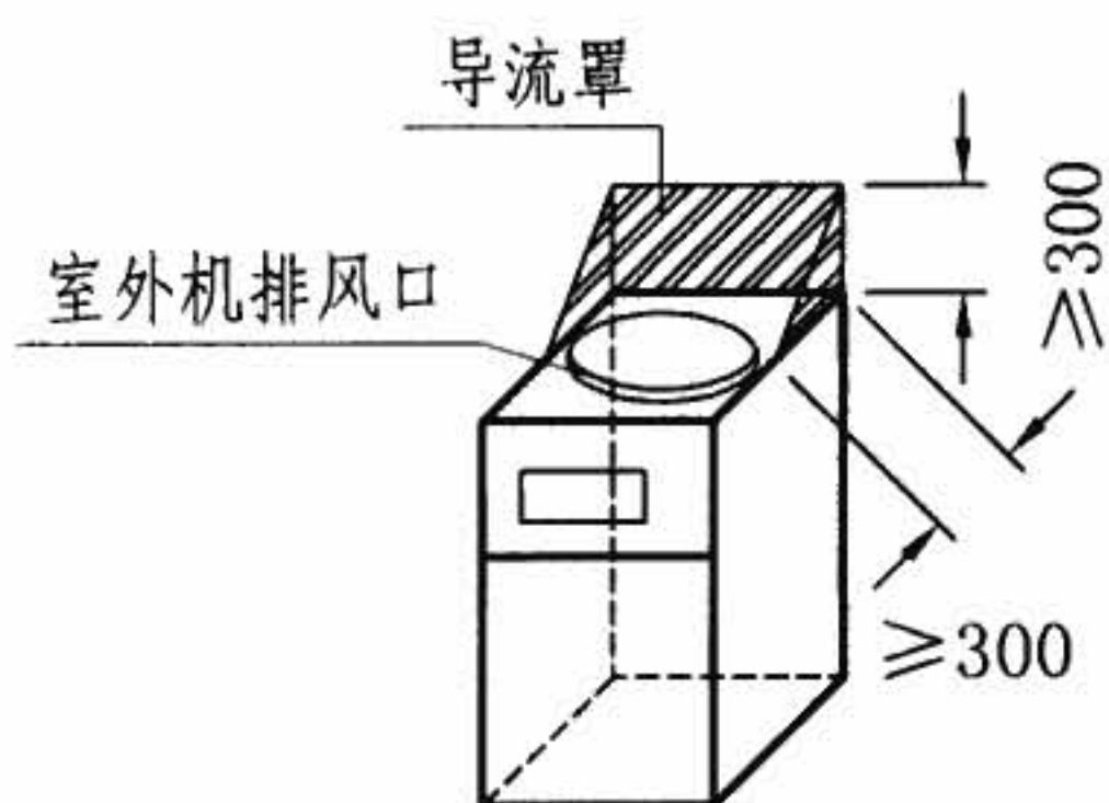
室外机安装导流风帽示意图
