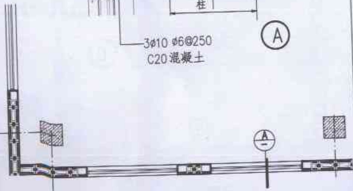
墙柱关系 3: 保温砌块墙脱离框架柱
