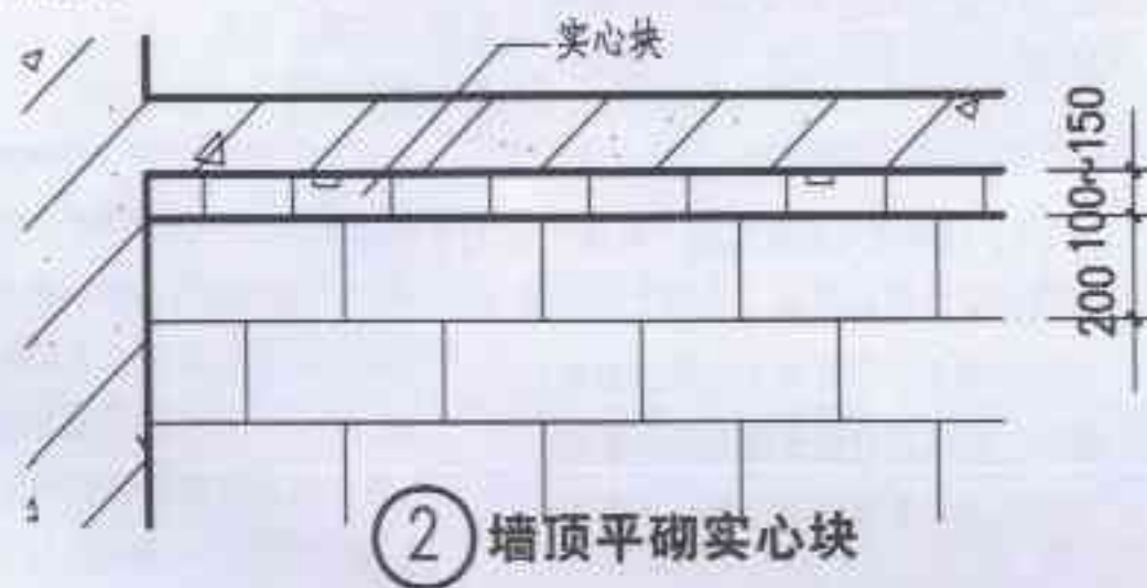
(2) 最上一皮砌块距梁100mm左右时，可用实心块平砌，用砂浆捻实。
