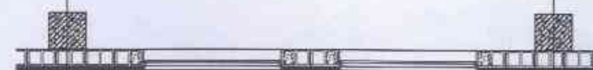
墙柱关系 3a 砌块墙包在框架柱外
