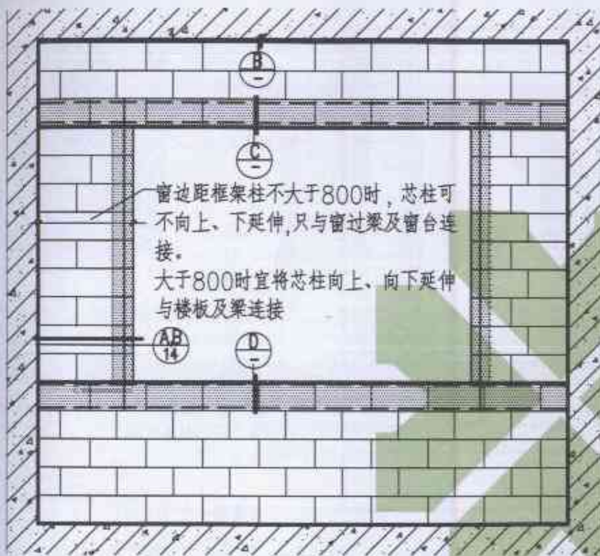
① 单洞口保温砌块墙拉结示例
