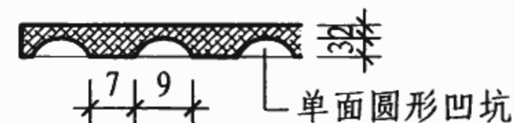
减振橡胶板剖面
