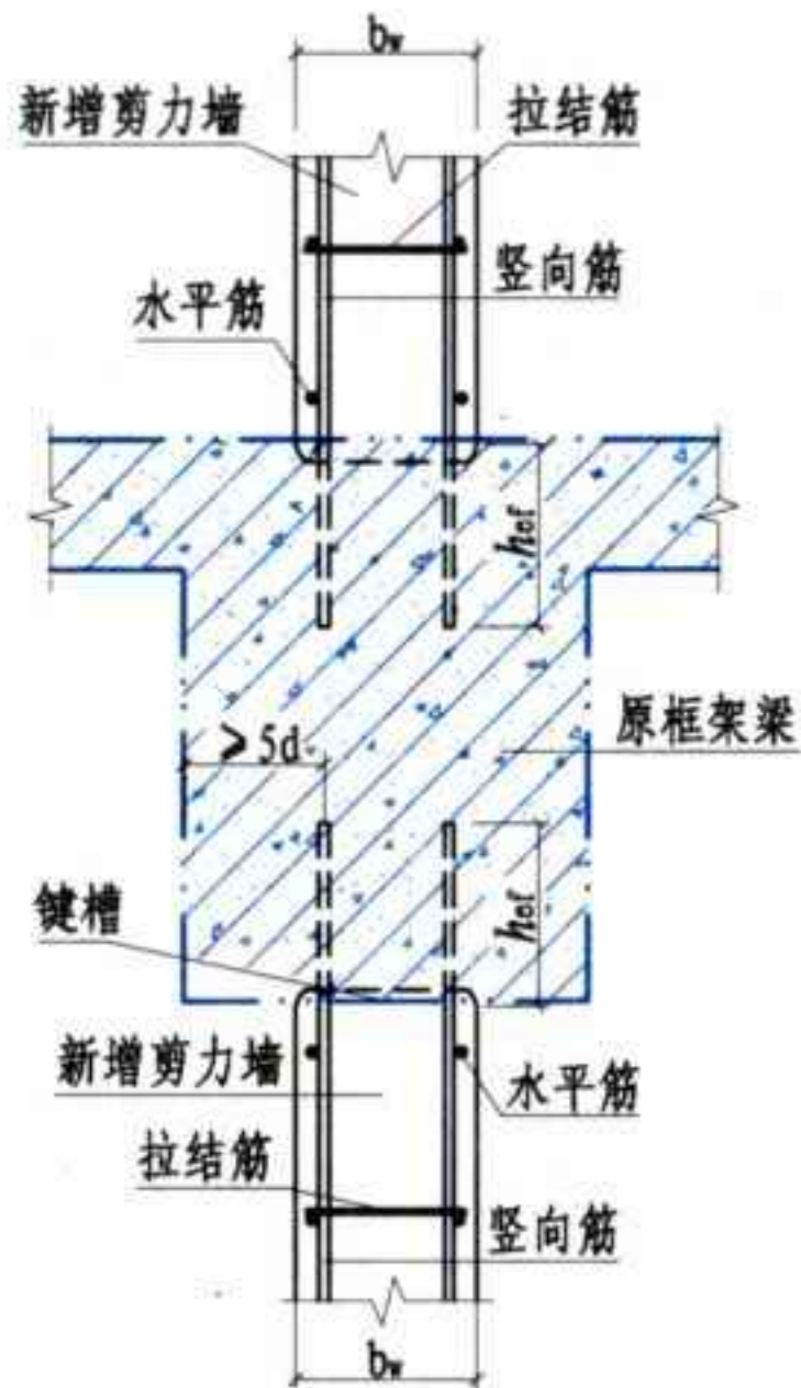
(b) 墙与梁宽度相差较大时, 竖筋化学植入梁
