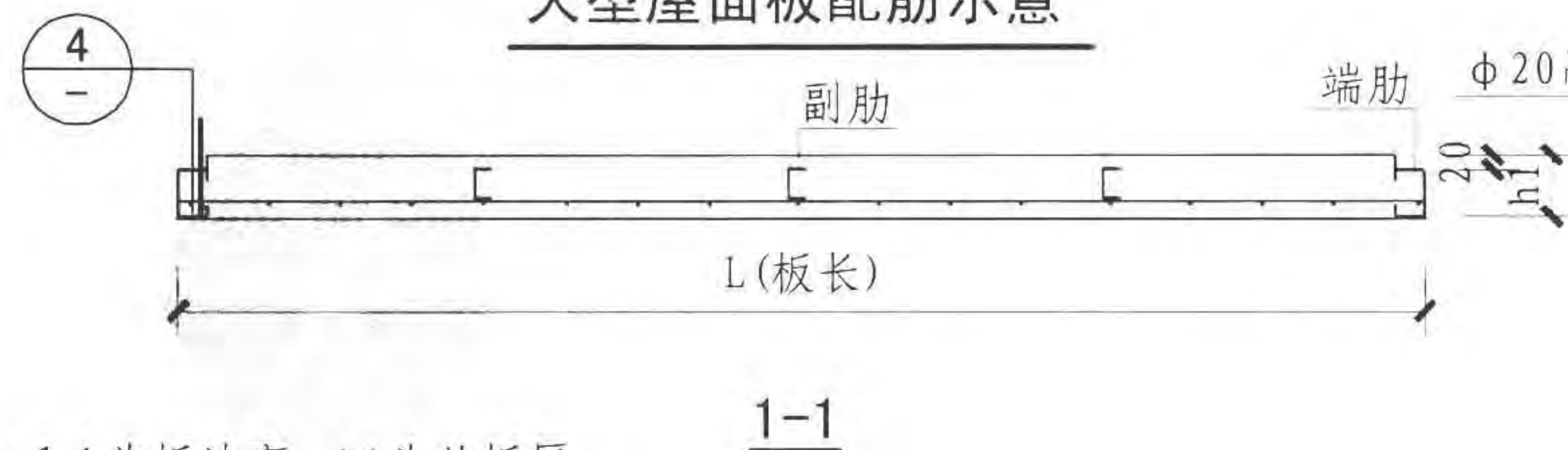
大型屋面板配筋示意
