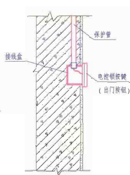
电控锁按键安装示意图
