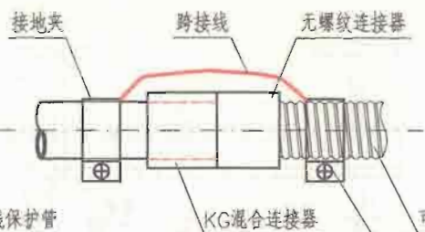
可挠金属电线保护管与钢管连接
