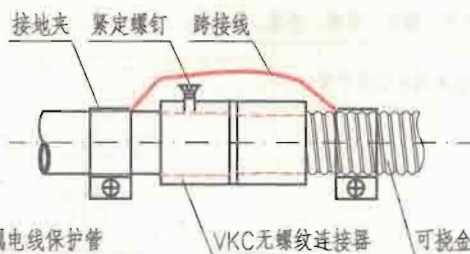
可挠金属电线保护管与钢管连接
