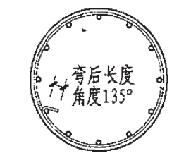
螺旋箍筋端部构造
