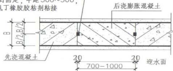
① 立墙或顶板后浇带防水构造 (二或三级防水)
