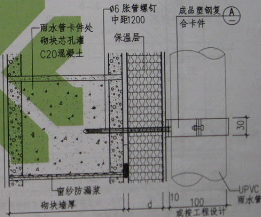
② 塑钢复合卡件 (用于轻集料混凝土砌块墙)
