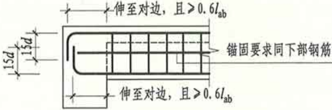
图4.12-2 受扭梁纵向钢筋端支座构造
