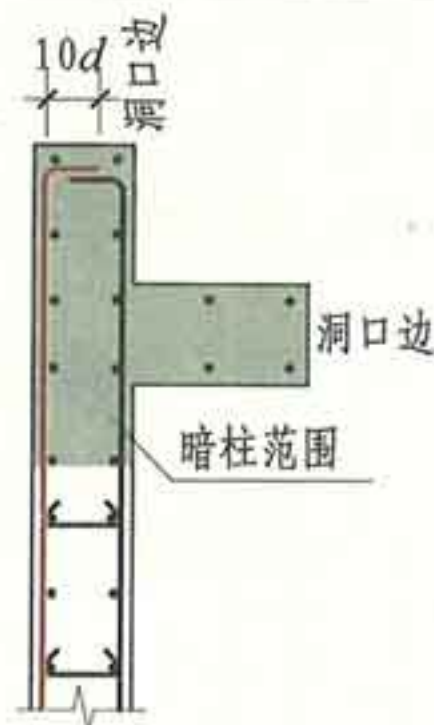
图3.5-2 墙体水平分布钢筋在转角外侧搭接
