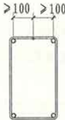
图1.17-1 焊接封闭箍筋
