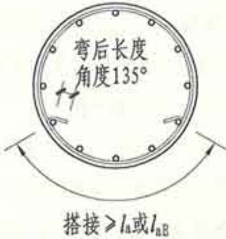
图1.17-3 圆形箍筋
