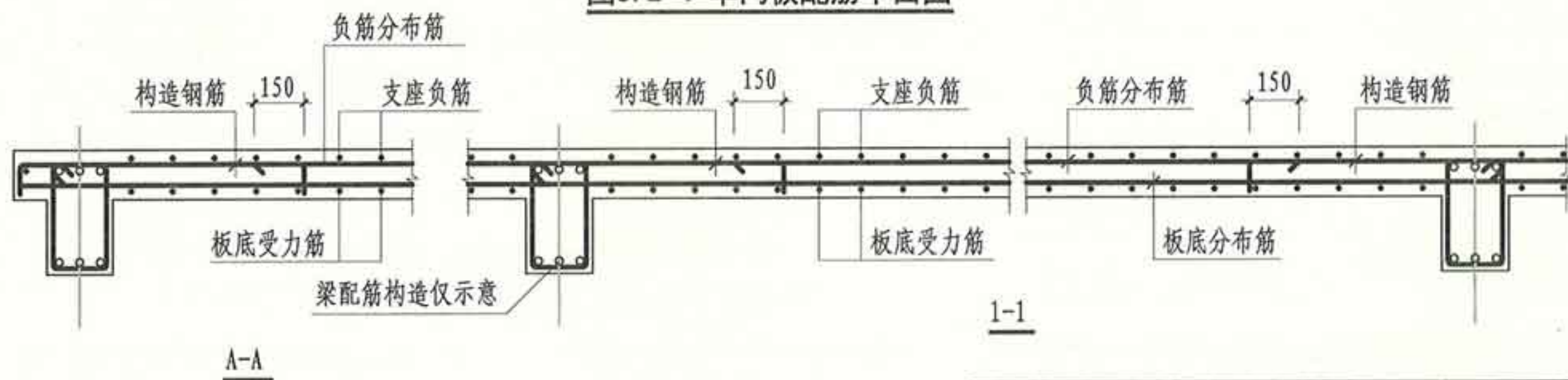
图5.2-4 单向板配筋平面图
