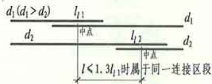
图1.8-2 直径不同钢筋搭接连接区段长度计算
