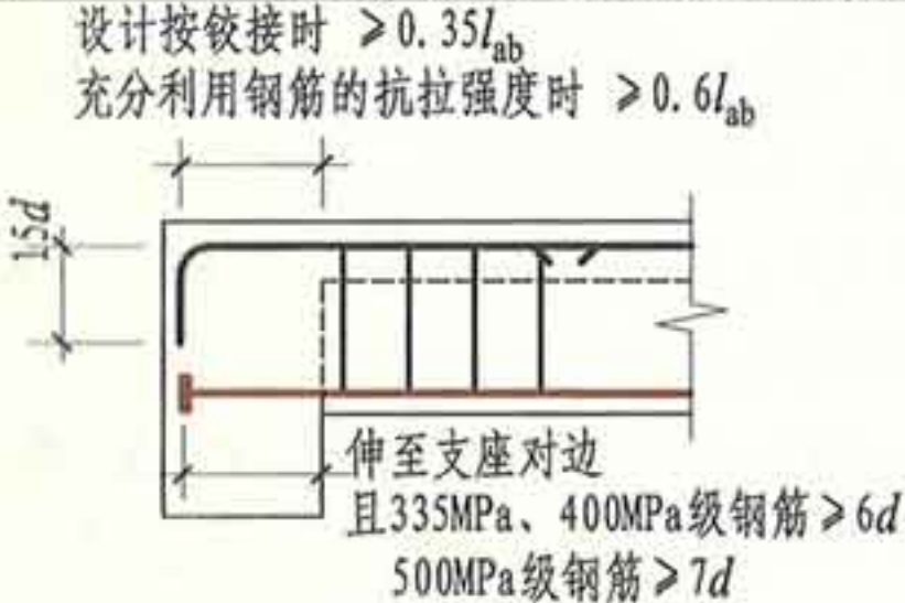
图4.11-3 下部钢筋端头带锚固板
