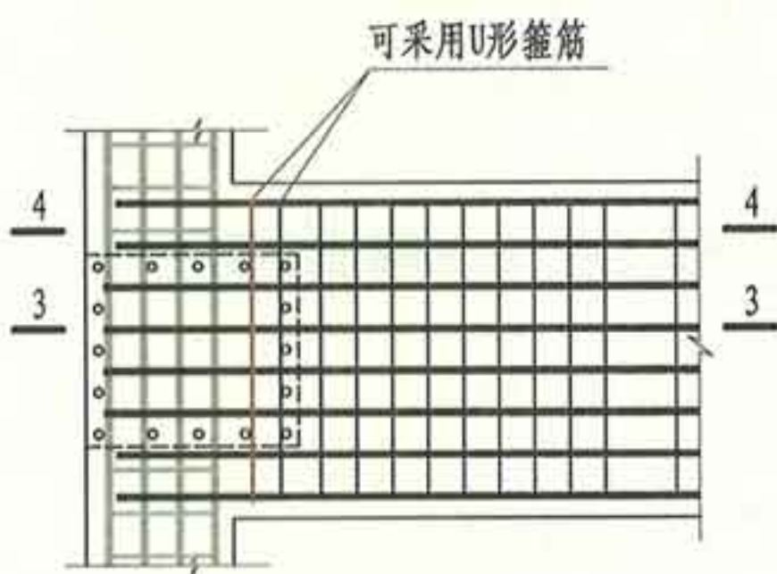
图4.9-4 宽扁梁端部平面构造 (二) 边梁宽度小于柱宽
