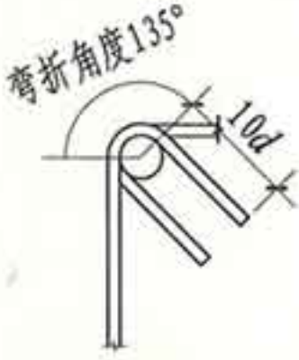
图4.12-4 受扭梁箍筋弯钩
