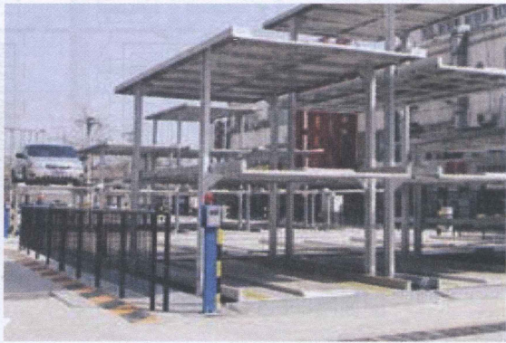
图B2-2 停车设备图（升起时）
