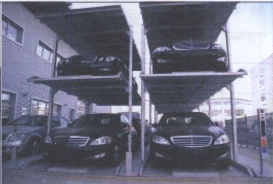
图B1-4 停车设备图（升起时）
