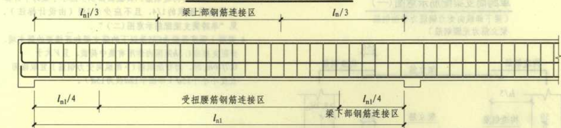
受弯剪扭非框架梁钢筋连接示意图
