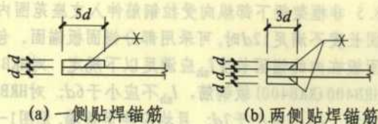
图1-11 贴焊锚筋锚固示意图
