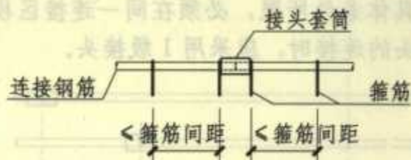
图1-18 机械连接接头套筒处箍筋布置示意图
