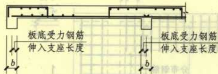
单向板板底受力筋锚固 (一)
