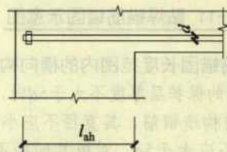
图1-10 非框架梁下部钢筋锚固板锚固
