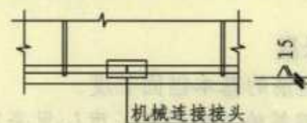
图1-4 机械连接接头的混凝土保护层厚度示意图
