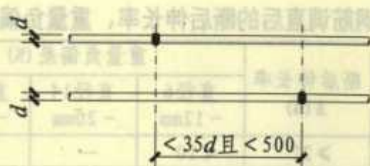
图1-19 同一连接区段焊接连接接头示意图
