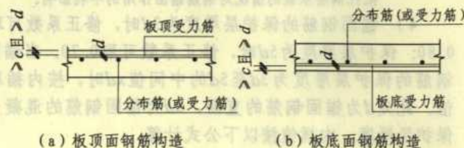
图1-2 板钢筋的混凝土保护层厚度示意图（一）
