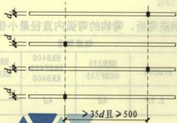
图1-20 同一连接区段50%焊接连接接头示意图
