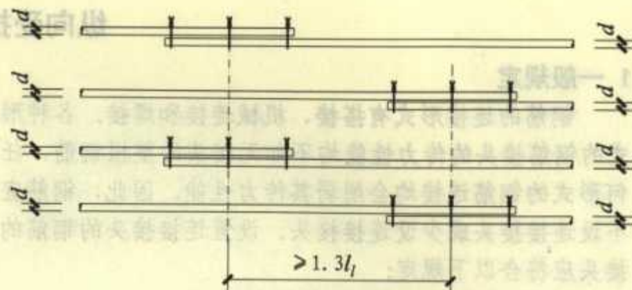
图1-14 50%绑扎搭接接头示意图 (搭接钢筋直径相同)
