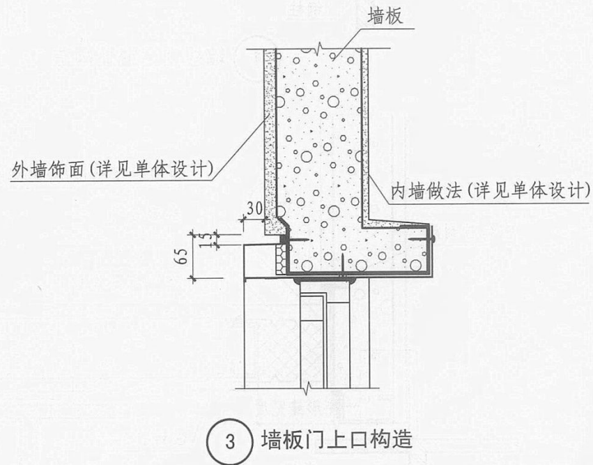
墙板门窗洞口纵剖面上、下节点构造详图
