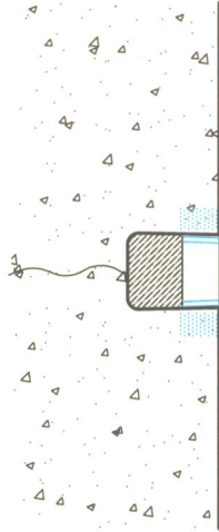
(4) 凹槽中刷涂PNC401防水材料
