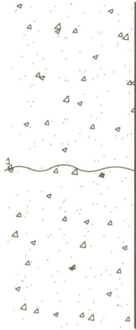
(1) 水压与渗漏量小的裂缝
