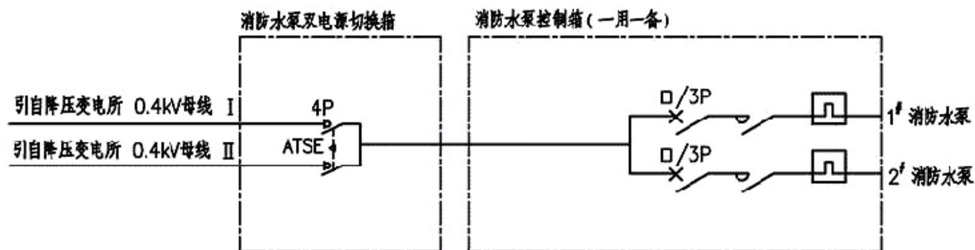
消防水泵配电系统图
