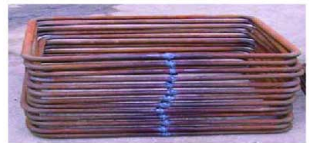
图4-24 箍筋闪光对焊
