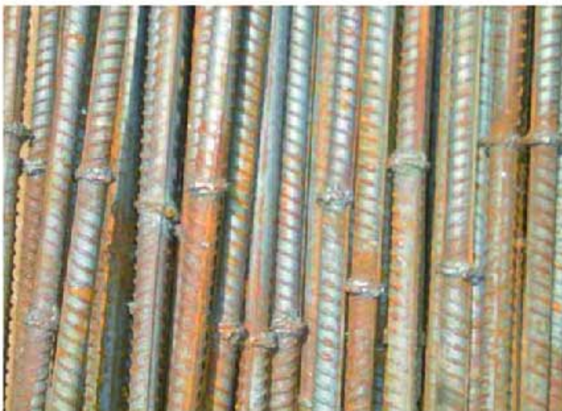
图4-22 钢筋闪光对焊接头
