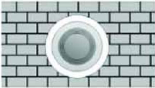
普通工艺圆形结构，开槽预埋强度不高，铜螺纹容易拧裂
