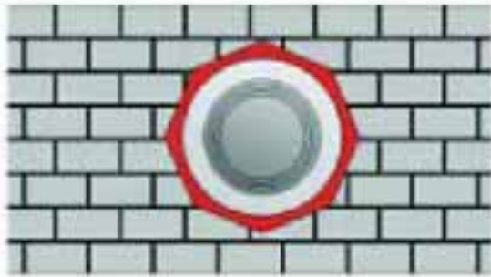
中财八角卡位结构，开槽预埋强度高，不锈钢卡环，二次加固
