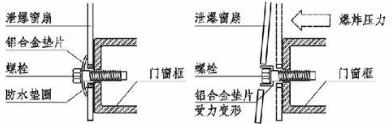
(a) 安装后的正常状态 (b) 内部爆炸压力释放状态
