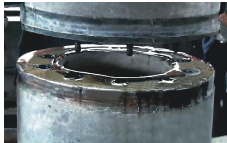
连接状态 (连接件对接施工更快, 环氧树脂解决防腐、密封提高波的传播速度)
