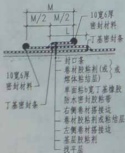
① 平面冷粘或热熔封边
