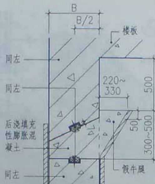
(b) 浇筑混凝土
