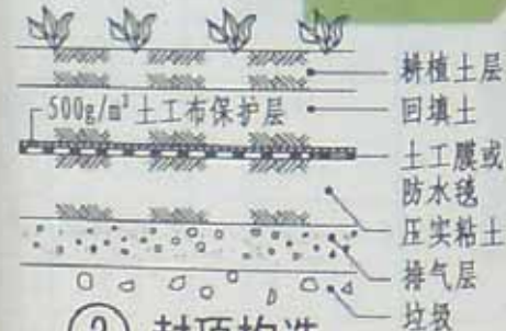
② 封顶构造
