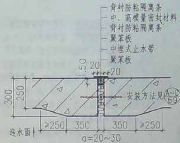
④ 外墙 (防水层构造同①)
