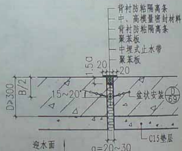
⑥ 底板 (防水层构造同③)
