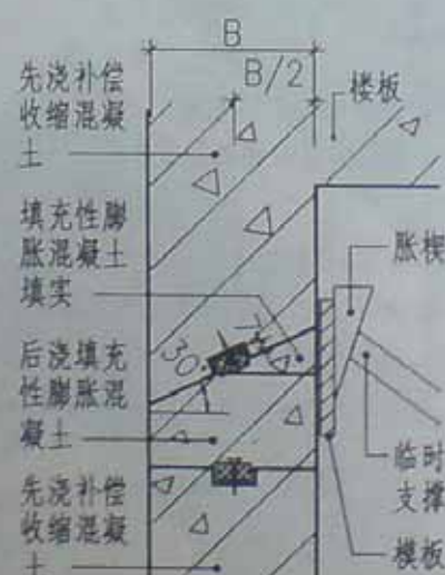
(c) 填充混凝土
