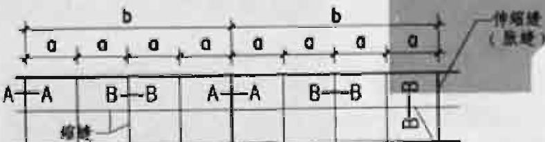
现浇院路混凝土路面分块平面
