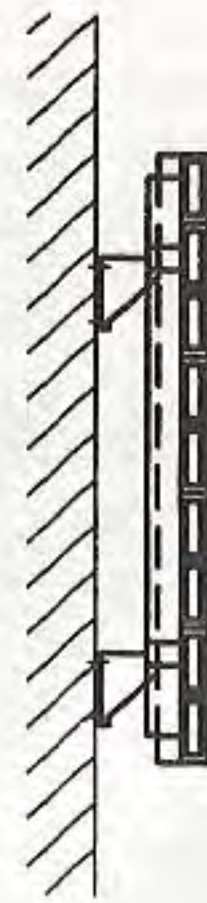
扁管单板对流散热器安装 (单板不带对流)
