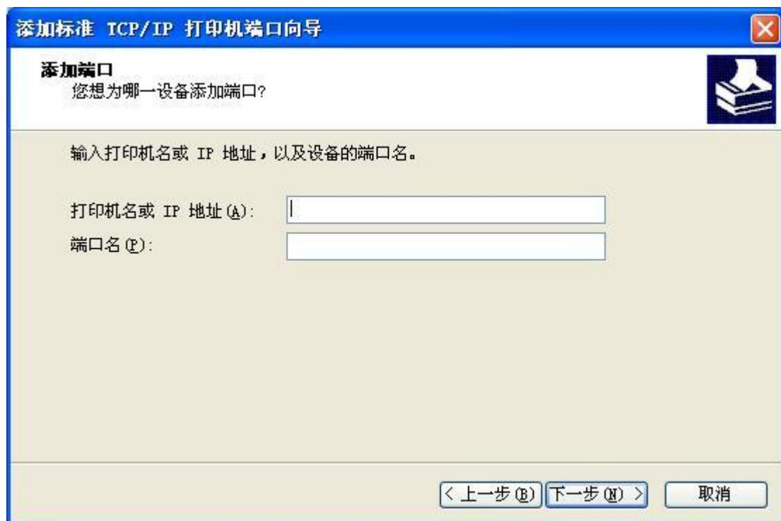
输入打印机的“IP 地址”，如下图所示。
