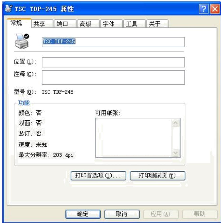
1、选择正确的打印机通讯端口，如“并口”一般选择“LPT1”，“串口”一般选择“COM1”，“USB”一般选择“USB001”，“以太网接口”则选择“添加端口”，如下图所示。
