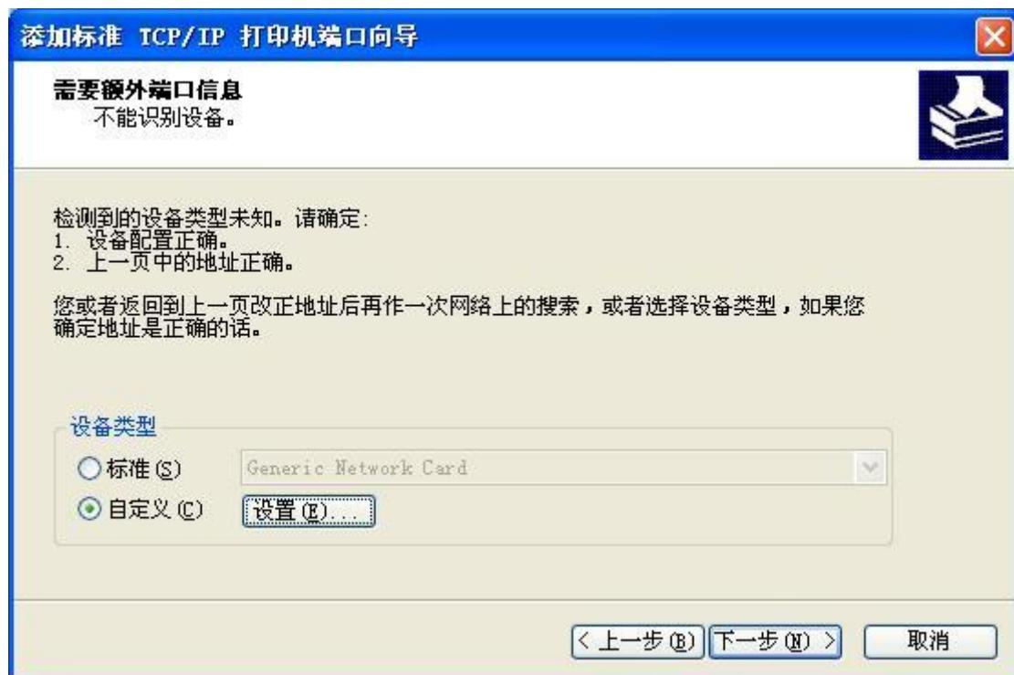
然后选择“自定义”---“设置”，如下图所示，确认以下图示信息并选择“确定”。
