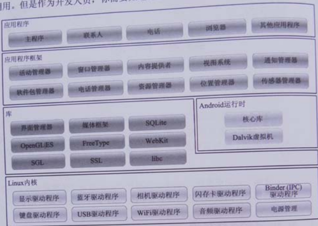
图2-1 Android系统架构
