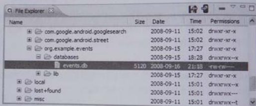
图9-1 SQLite将整个数据库存储在一个文件中
