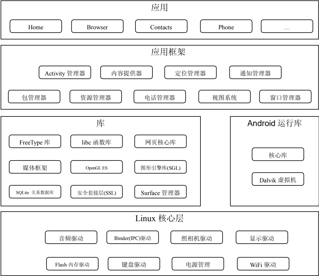
图 1-1 Android 框架层次的主要构成
