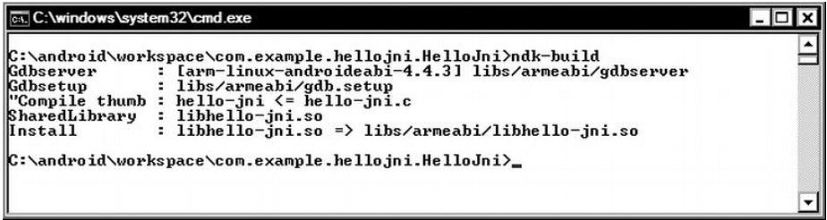
图 2-9 用 ndk-build 对原生组件进行构建
