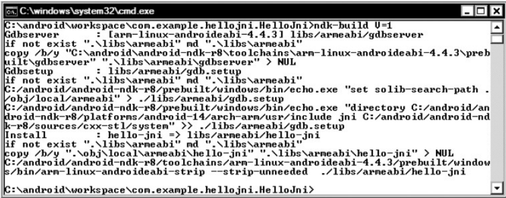
图 2-14 ndk-build 脚本显示构建命令
