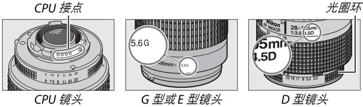
使用配备光圈环的 CPU 镜头时，请在最小光圈（最高 f 值）处锁定光圈环。
