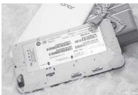
④ ● 背盖可拆但电池无法更换
