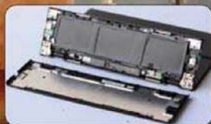
● 与屏幕相连的底座部分容纳了硕大的锂电池
