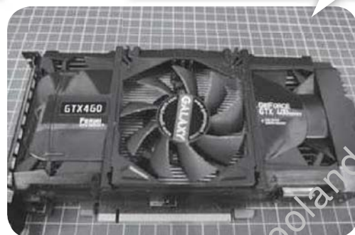
风扇下面鳍片上的尘土更难清理
