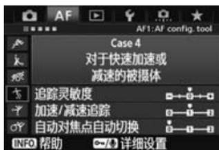
适于追踪速度容易突然大幅度变化的移动被摄体。对突然移动、突然加速/减速或突然停止的被摄体有效。
