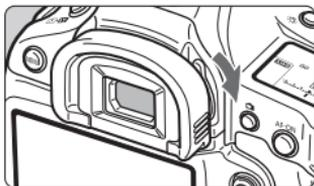
如果使用自拍或B门并且不通过注视取景器拍摄照片，进入目镜的杂散光可能会影响曝光并导致黑暗的照片。要避免发生上述情况，请按照如图中箭头所示方向滑动目镜遮光挡片拨杆，以关闭目镜。
