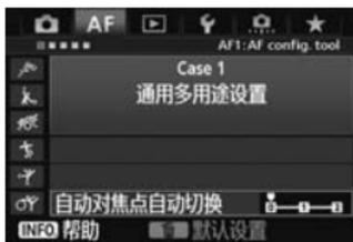
该项设定自动对焦点追踪大幅度向上、下、左或右移动的被摄体时自动对焦点的切换灵敏度。
