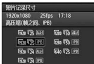
使用 [ **4**: 短片记录尺寸 ]，可以设定短片的图像尺寸、每秒帧频和压缩方法。帧频根据 [ **3**: 视频制式 ] 设置自动切换。
