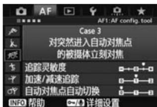
一旦自动对焦点开始追踪被摄体，该设置会使相机对不同距离的连续被摄体对焦。如果在目标被摄体前方出现新的被摄体，相机会开始对新被摄体对焦。并且当您想要始终对最近的被摄体对焦时有效。
