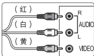
**2** 将AV连接线连接到电视机。
