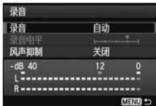
可以在拍摄短片的同时使用内置单声道麦克风或市面有售的立体声麦克风录制声音。还可以自由调节录音电平。用 [
