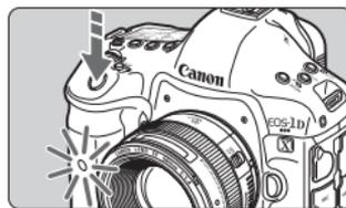
如果按下快门按钮时不通过取景器观看，请在拍摄前关闭目镜遮光挡片（第179页）。如果在拍摄照片时有杂散光进入取景器，则可能会影响曝光。
