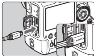
**1** 将随机提供的AV连接线连接到相机。
