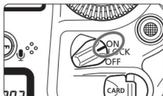
5 将相机的电源开关置于<ON>。
