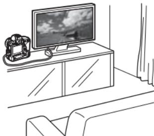
使用随机提供的AV连接线或HDMI连接线 HTC-100 (另售) 将相机连接到电视机。然后就可以在电视机上回放拍摄的短片和静止图像。
