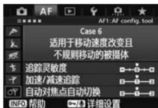
适用于追踪速度可能突然大幅度变化的移动被摄体。此外，如果目标被摄体大幅度向上、下、左或右移动并且难以对其对焦，自动对焦点会自动切换以追踪被摄体。
