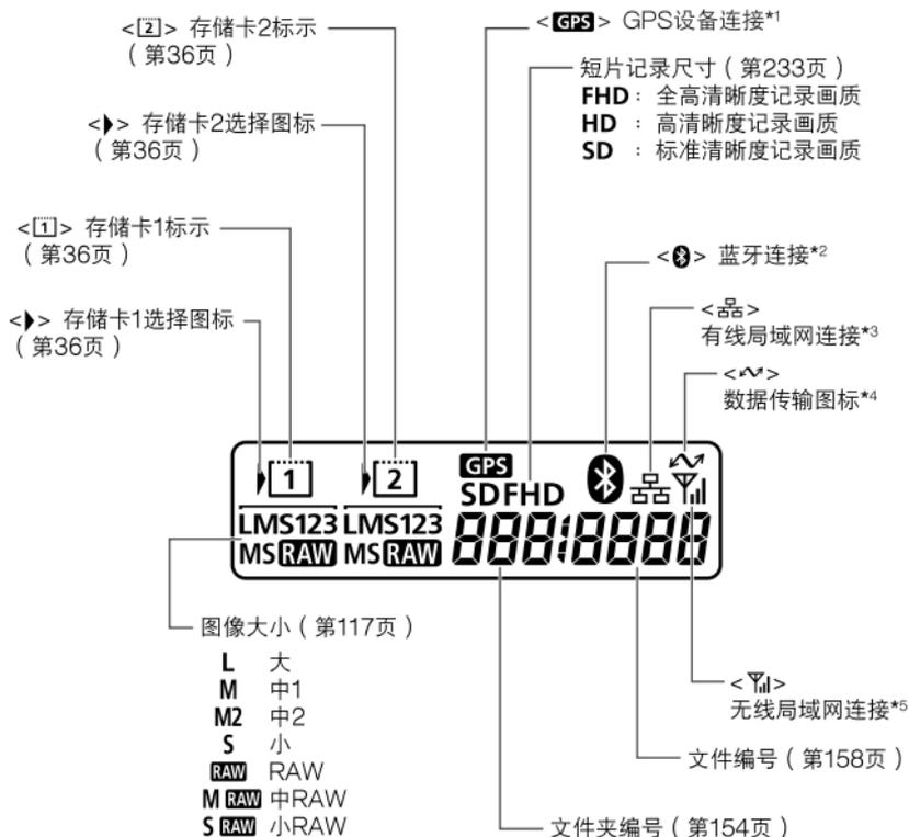
\*1: 当相机上安装有GPS接收器GP-E1/GP-E2或无线文件传输器WFT-E6上安装有市售的Bluetooth GPS设备时显示。
