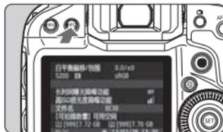
在相机处于拍摄状态下按下<INFO.>按钮时，可以显示 [ 显示相机设置 ]、[ 电子水准仪 ] (第61页) 和 [ 显示拍摄功能 ] (第359页)。
