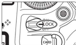
如果在电源开关置于<LOCK>时尝试使用锁定的相机控制之一，会在取景器中和机顶液晶显示屏上显示<L>。还会在拍摄功能的设置画面上显示 [ LOCK ]。
