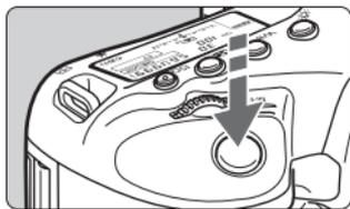
在拍摄短片时，还可以通过完全按下快门按钮拍摄静止图像。
