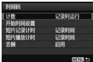
时间码是自动记录的时间基准，用于在短片拍摄期间同步视频和音频。以下列单位始终记录该信息：小时、分钟、秒钟和帧。该信息主要在短片编辑期间使用。用 [ 5：时间码 ] 设定时间码。
