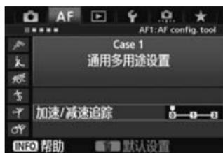
该项设定追踪因突然开始移动或停止等而速度可能突然发生大幅度变化的移动被摄体的灵敏度。
