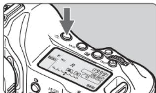
按<LAMP>按钮打开 ( 06 ) 或关闭机顶和机背液晶显示屏的照明。B门曝光时，完全按下快门按钮会关闭液晶显示屏照明。
