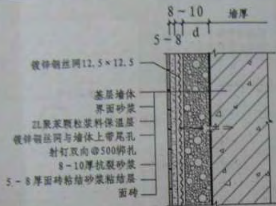
① 贴面砖外墙 (基本构造)
