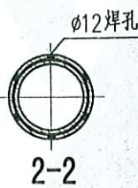
相同口径钢管对接
