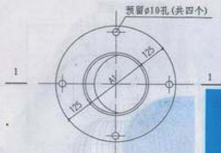
① 无动力排气风帽底座接口钢板
